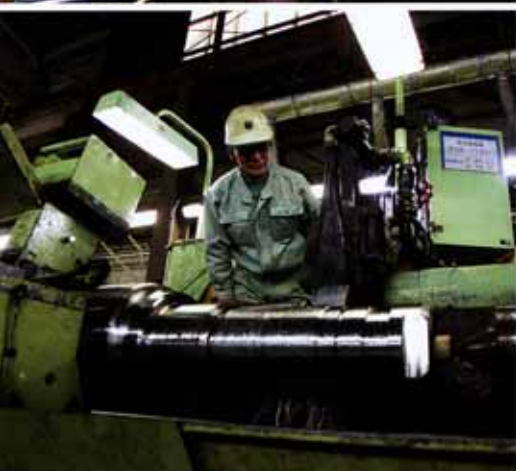
上/ツルツルした高橋さんの指先。指紋がない時期もあった 左上/段取りで手を抜くと、後で苦勞することになる。若手に治具の調整を指導 左下/N Cマシンで大型のロールを研磨。しかし、最終仕上げは人の手に頼る
