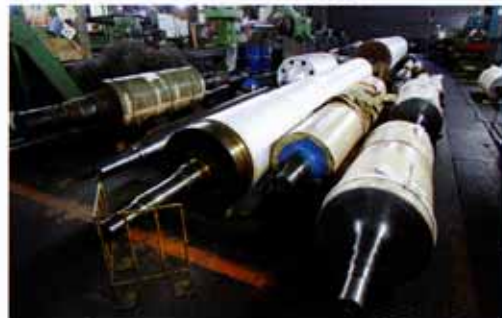
左/用途に応じて直径、長さ、重さがさまざまなロールを手がける。写真は製鉄や製紙に使われる大型ロール 中・右/治具の数々。段取り時間短縮・加工スピードアップのために、使い勝手のよい治具を自作する
