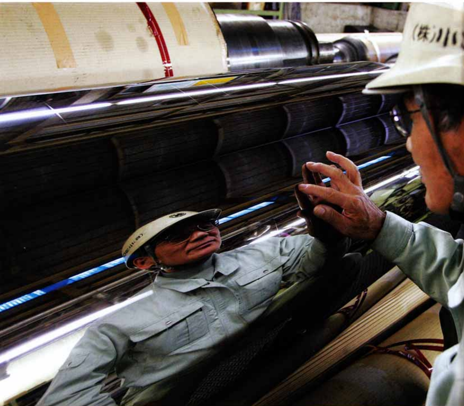
素人の目には真っ平らな鏡面にしか見えないが、高橋さんは手触りでロール表面にひと筋の微妙な段差を見つけた
